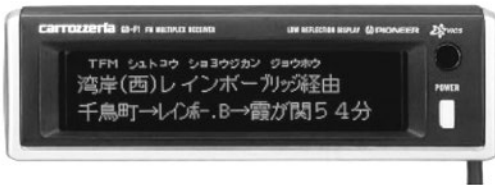
図2 1997年パイオニアで生産された 64x256 PM型緑色ディスプレイ
